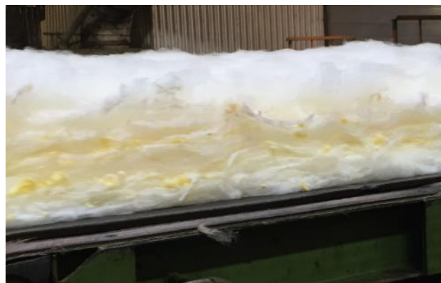
Abbildung 21: Werkstoffliche Wiederverwertung von Glaswolle: Zerfaserte Produktionsabfälle (gelb) in neuer Glaswolle (weiss). (Quelle: ERM)
