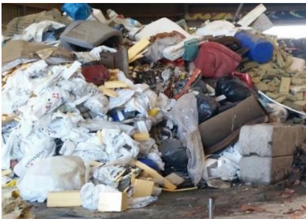
Abbildung 2: Brennbare Baustoffe bei Baustoffsortierer mit erkennbaren mineralölbasierten Dämmmaterialanteilen. (Quelle: ARV)
