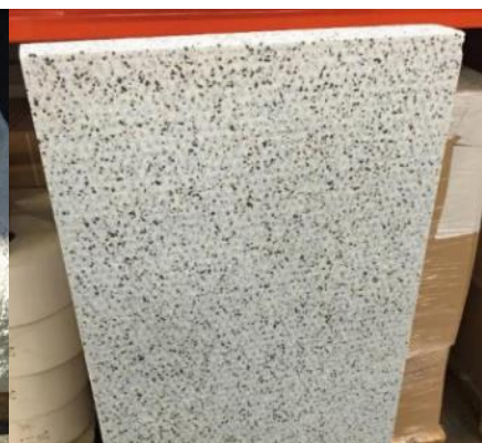
Abbildung 19: Rezyklatplatte aus zerkleinertem EPS. (Quelle: ERM)
