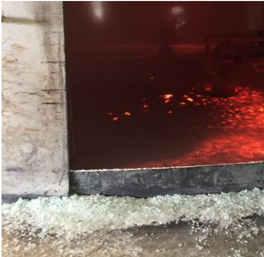
Abbildung 10: Elektroschmelzofen in der Glaswolleproduktion bei Hersteller 2 (Quelle: ERM)
