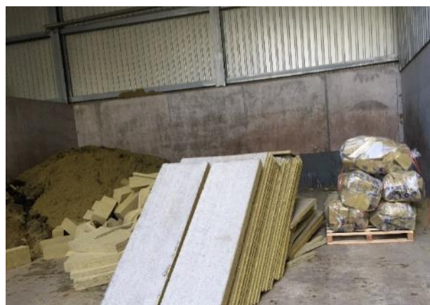
Abbildung 15: Rücknahme von Steinwolle-dämmung bei einem Hersteller. (Quelle: ERM)
