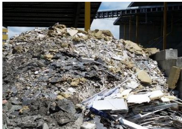
Abbildung 3: Inertstofffraktion eines Baustoffsortierers mit erkennbaren mineralischen Dämmmaterialanteilen. (Quelle: ARV)
