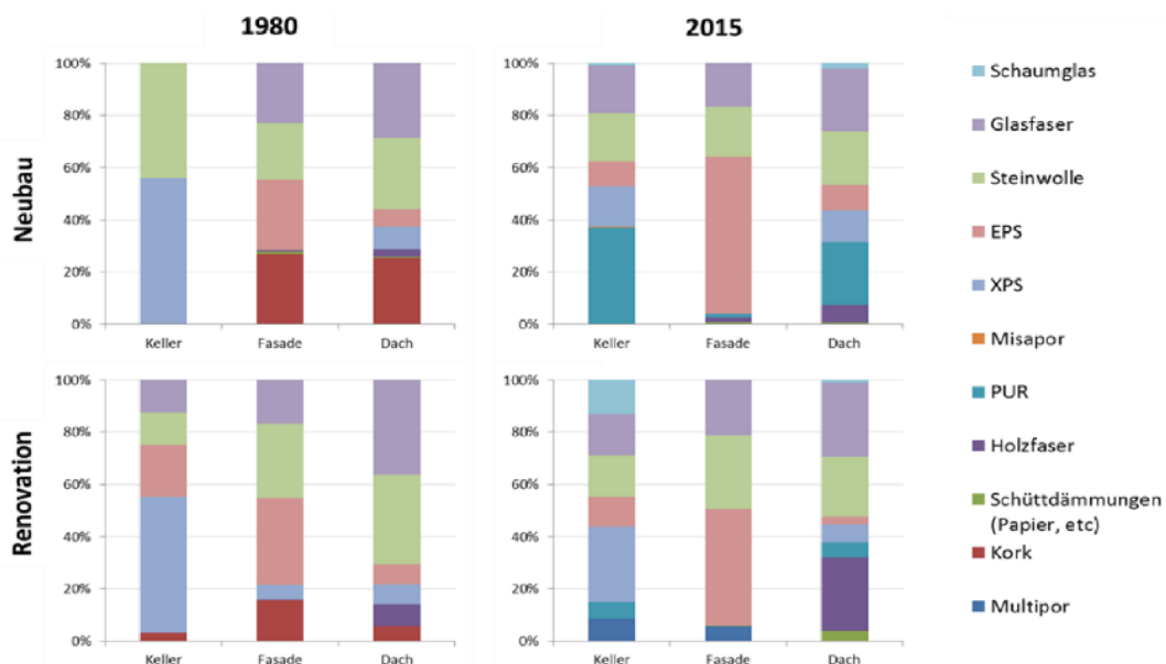
Abbildung 16: Annahmen zu den Flächenanteilen der Dämmmaterialfraktionen für Neubau und Renovation, zum Zeitpunkt 1980 sowie 2015. (Quelle: Jakob et al., 2016)
