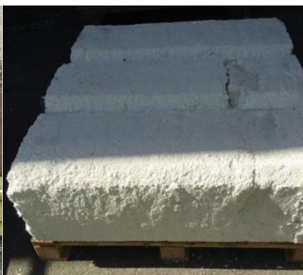
Abbildung 18: Gepresster EPS aus der Sammlung mit Sammelsäcken beim Hersteller, v.a. Schnittabfälle von Baustellen. (Quelle: ERM)
