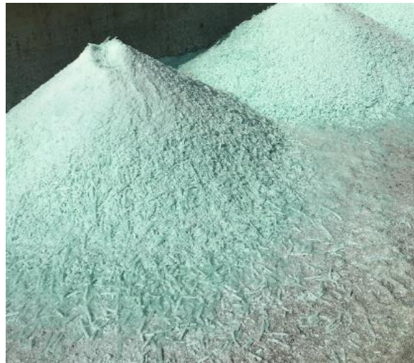
Abbildung 11: Erkaltes Glas: Der Schmelzofen läuft weiter, auch wenn die Produktion unterbrochen werden muss. Das Glas wird später wieder dem Schmelzofen zugegeben. (Quelle: ERM)
