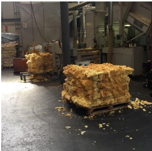
Abbildung 12: Gepresste Glaswolle, welche von Hersteller 2 als minderwertiges Produkt weiterverkauft wird. (Quelle: ERM)
