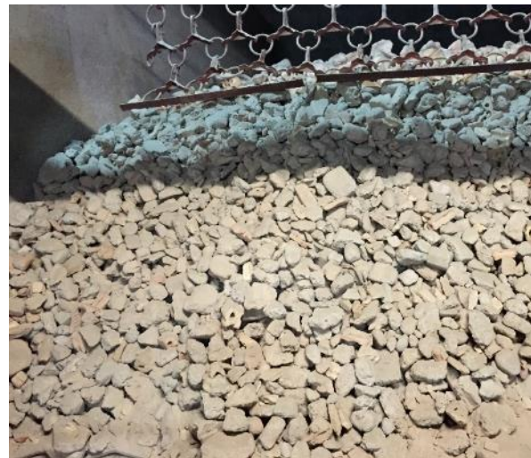
Abbildung 13: Mischabbruch als Rohstoffersatz für die Steinwolleproduktion. (Quelle: ERM)
