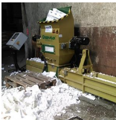
Abbildung 17: EPS Presse. Das EPS wird der Maschine dabei händisch zugegeben. (Quelle: ERM)
