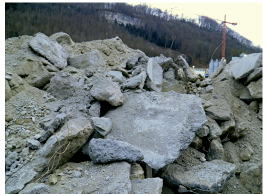
Fig. 3: Betonabbruch mit leichter Armierung (Foto: D. Hiltbrunner).
