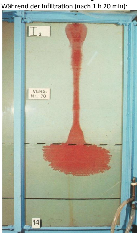
Modellversuch zur Einsickerung von Dichlormethan Während der Infiltration (nach 1 h 20 min):
