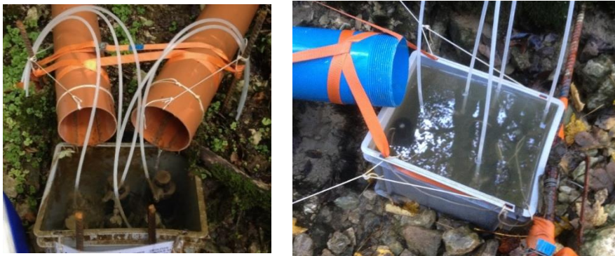
Abbildung 17 Beispiel für eine Ausrüstung von Quellen, die eine konstante Immersionstiefe der integrativen Passivsammler des Typs Sorbicell gewährleistet. Nach (Renard et al. 2017).
