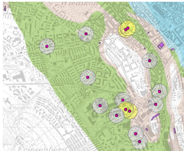
Abbildung 5-4: GIS-Auswertung mit 100 m-Pufferbereichen um untersuchungsbedürftige CKW-Standorte; gelb: Standortdichte günstig (2 oder mehr Standorte < 100 m)
