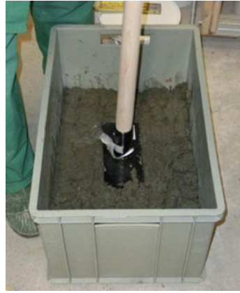
Abbildung 10 Verdichtung des Schlammes mit Stampfer
