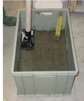
Abbildung 11 Fertig verdichteter Schlamm, bereit für Kugeltest
