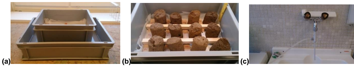
Abbildung 5: Apparatur zur Befeuchtung der Proben aus ungestörtem Boden: (a) Becken zur Befeuchtung der Proben; (b) Proben während der Befeuchtung; (c) Wasserstrahlpumpe zur Erzeugung eines Vakuums im Plastikbeutel.
