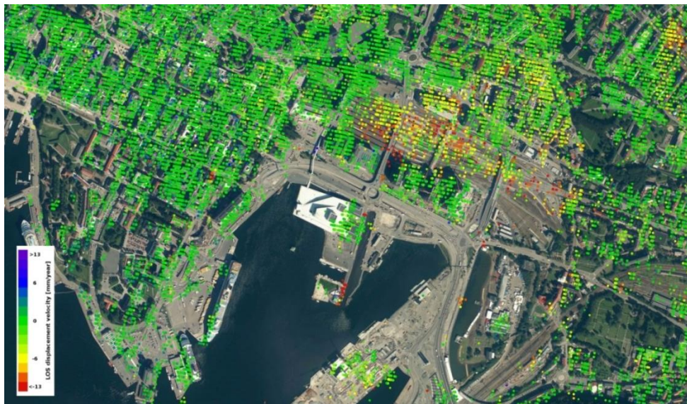
Abbildung 5: Bodensenkungskarte von Oslos Hauptbahnhof. Sentinel-1 Aufnahmen vom 26.12.2014 und vom 28.10.2016 visualisieren eine jährliche Absenkung des Hauptbahnhofs von 12 bis 18 Millimeter. 28)
