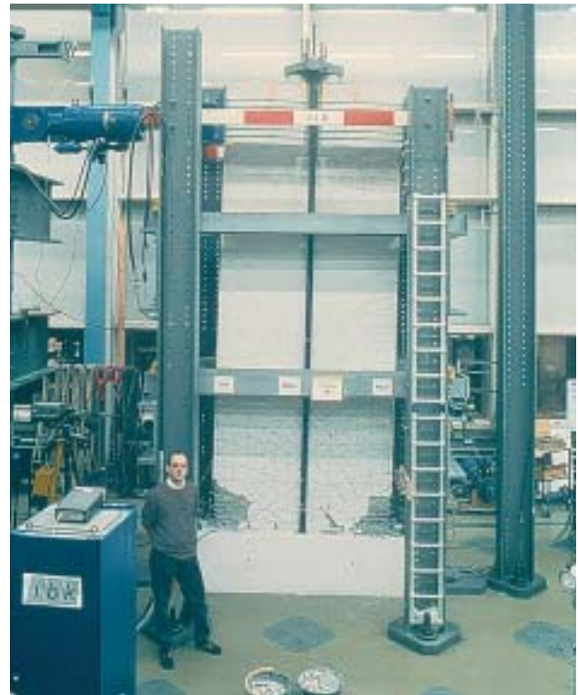
23/1 Statisch-zyklische Versuche am unteren Teil von 6-stöckigen Stahlbetontragwänden im Massstab 1:2 haben die Wirksamkeit einer duktilen Gestaltung auf eindruckliche Weise demonstriert [Da 99]. Mit kapazitätsbemessenen Wänden wurde im Vergleich zu konventionell d.h. nach der SIA-Norm 162 bemessenen Wänden ohne nennenswerten Mehraufwand eine rund 3 bis 4 mal grössere Erdbebensicherheit erreicht.
