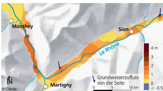
Abb. 7 Hochwasserereignis vom Oktober 2000 im Rhonetal: Ausschnitt aus der Karte der maximalen Amplitude des Grundwasserstandes am 16. Oktober 2000 [12].
