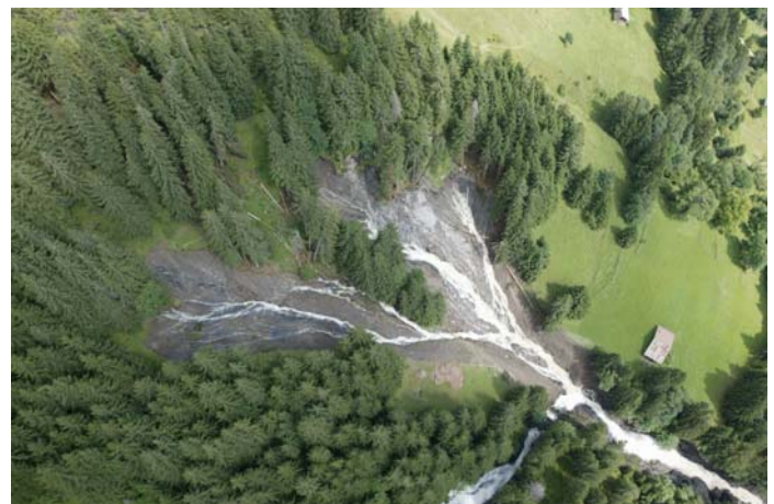
Abb. 8-2: Auslösungsmechanismen von Murgängen: links: Sohlenverflüssigung im Tanzhubelbächli (7-1) (Foto: S. Zingg) rechts: Fortsetzung einer Hangmure im Gerinne im Schwendibach (3-1) (Foto: Flotron AG)
