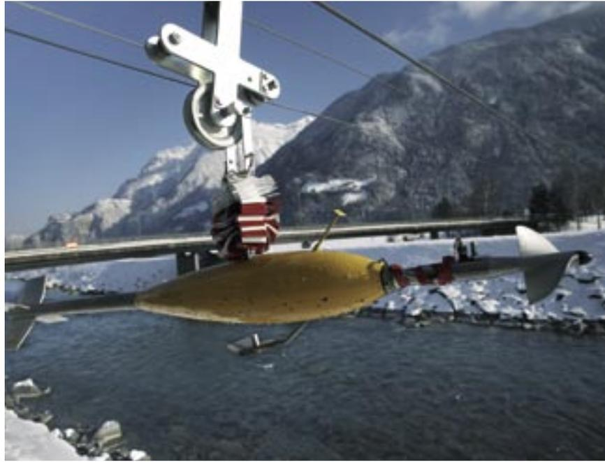
**In der Kalibrieranlage des BWG in Ittigen BE (siehe Kasten) werden unter anderem hydrometrische Messflügel geeicht. Mit diesem Instrument lassen sich die Fliessgeschwindigkeiten in den Gewässern bestimmen.**
