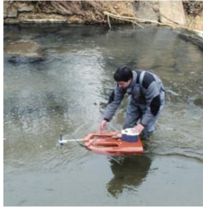
Bei der pneumatischen Pegelmessung (links) lässt sich anhand der Druckunterschiede der Wasserstand ermitteln. Die Akustikdopplermessung (rechts) dient sowohl der Bestimmung der Fließgeschwindigkeit als auch der Wassertiefe.
