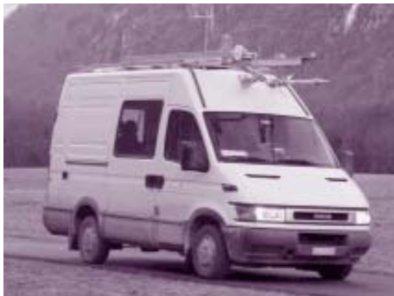
Abbildung 5.9.: Beispiel eines der beiden mobilen Messfahrzeuge (Paul Scherrer Institut) zur Erhebung der räumlichen Verteilung von Aerosolen und Gasen.
