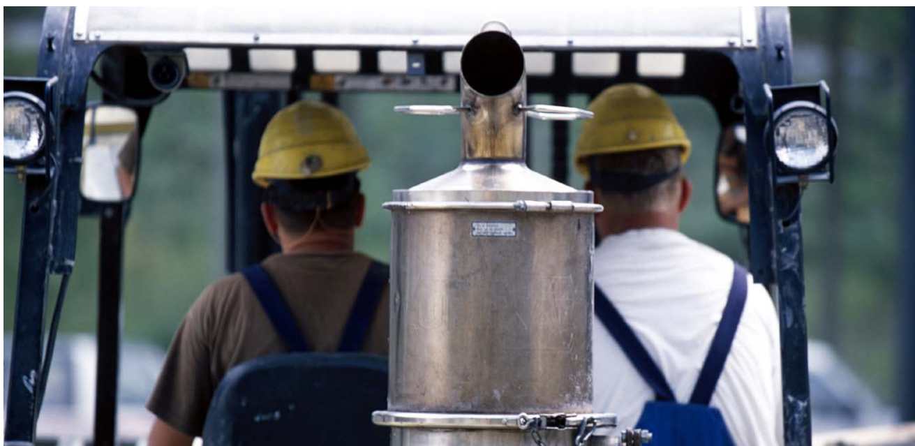
Fitre à particule installé sur un engin de chantier sur le site de la NFLA à Amsteg (UR)
