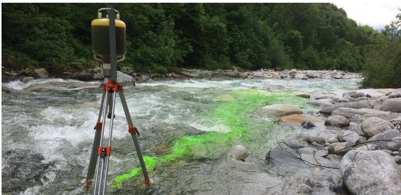
Mesures de débit par traçage (uranine) dans les petits cours d'eau, ici dans la Mera à Soglio (GR)
