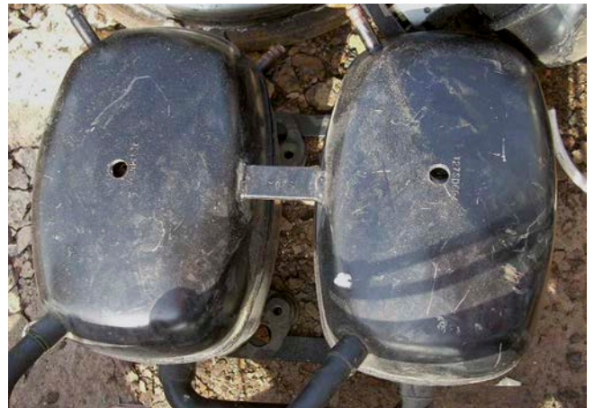
Angebohrte Kältekompressoren können nach dem «grünen» Kontrollverfahren exportiert werden.
