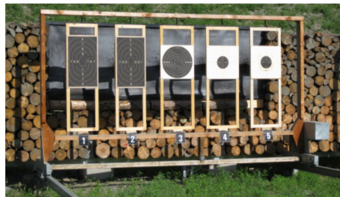
Fig. 23: Installation de tir à 25m Rossboden, Coire: chariot cible avec 5 cibles pivotantes, photo magma SA, 14.8.2009.
