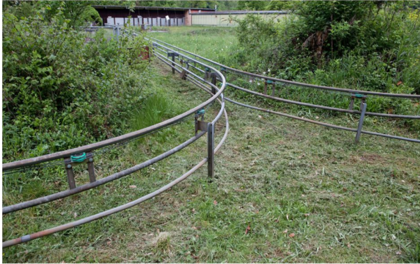
Fig. 28: Installation de tir de chasse Au, Embrach, installation de transport de cibles sanglier, [30].
