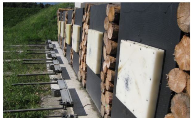
Fig. 31: Installation de tir de chasse à 100m de Rossboden, Coire, PBA derrière l'installation de transport de cibles, plaque frontale avec renforts, photo magma AG, 27.8.2009.
