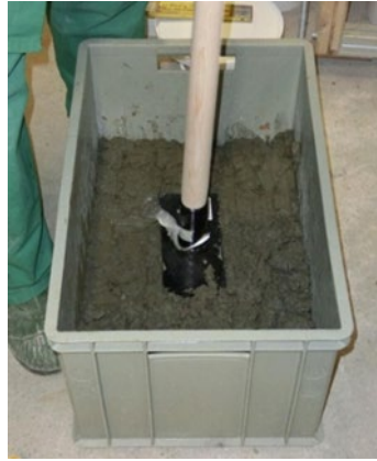
Figure 10 Compactage des boues à l'aide d'une dame
