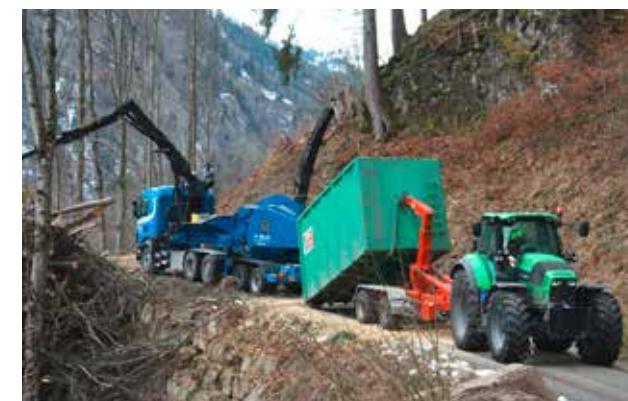
Fig. 30 Production de copeaux entièrement mécanisée à partir d'assortiments de qualité inférieure
