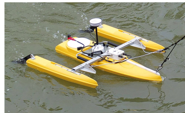
Akustik-Doppler-Messgerät auf einem Trimaran. Foto: Beat Sigrist
