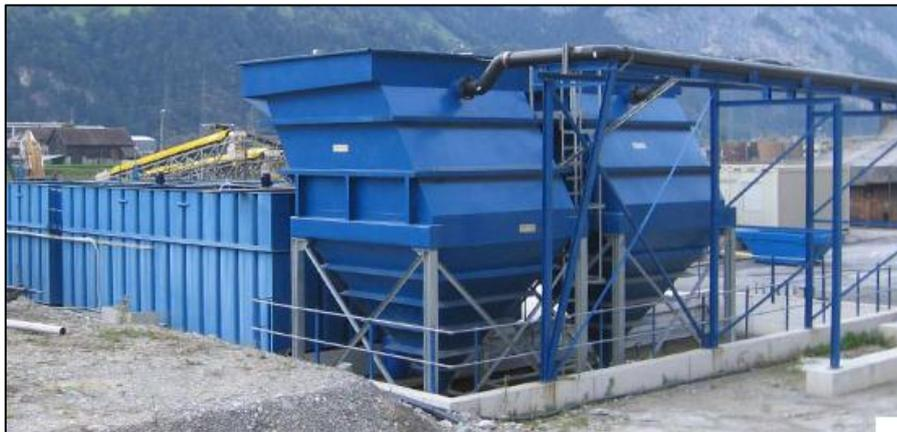
Abbildung 16: Wasserbehandlungsanlage Gotthard Basistunnel; Quelle: Leiblein GmbH (35)
