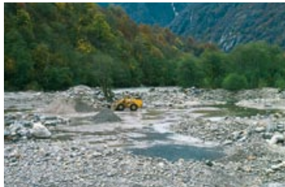
In Auengebieten soll die Kiesentnahmemenge die natürliche Ablagerungsrate nicht übersteigen: Brione Verzasca, TI (Foto: Auenberatungsstelle).
