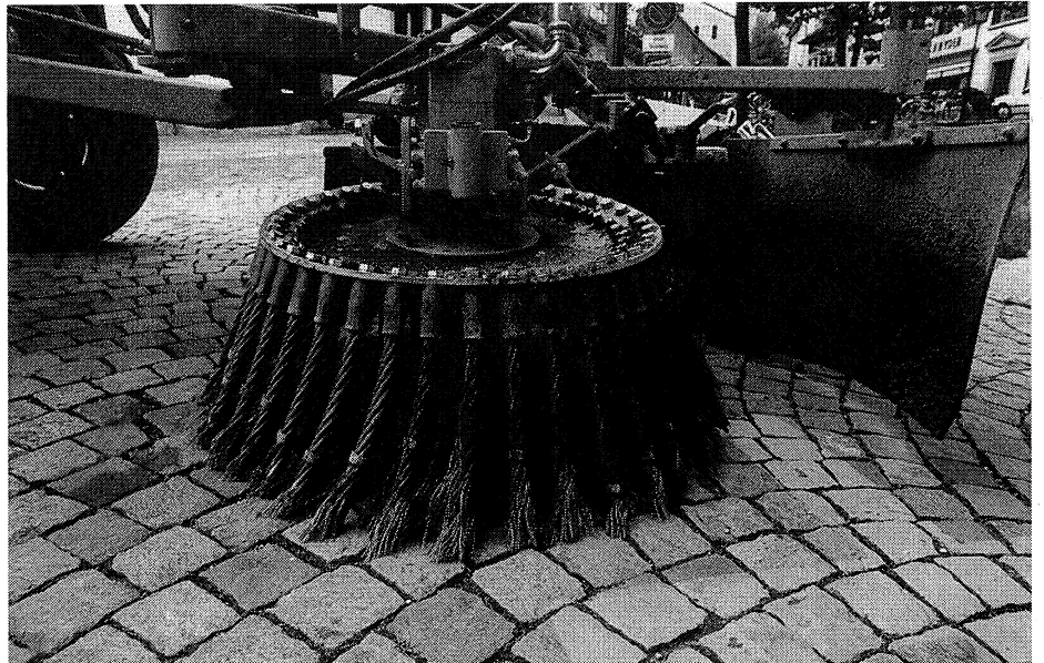
Jätbesen erlauben eine direkte Bekämpfung von Pflanzen am Strassenrand, wo diese nicht toleriert werden können. Mit diesem Modell aus Stahlseilborsten wird hoher Bewuchs entfernt, beispielsweise vor einer baulichen Sanierung.
