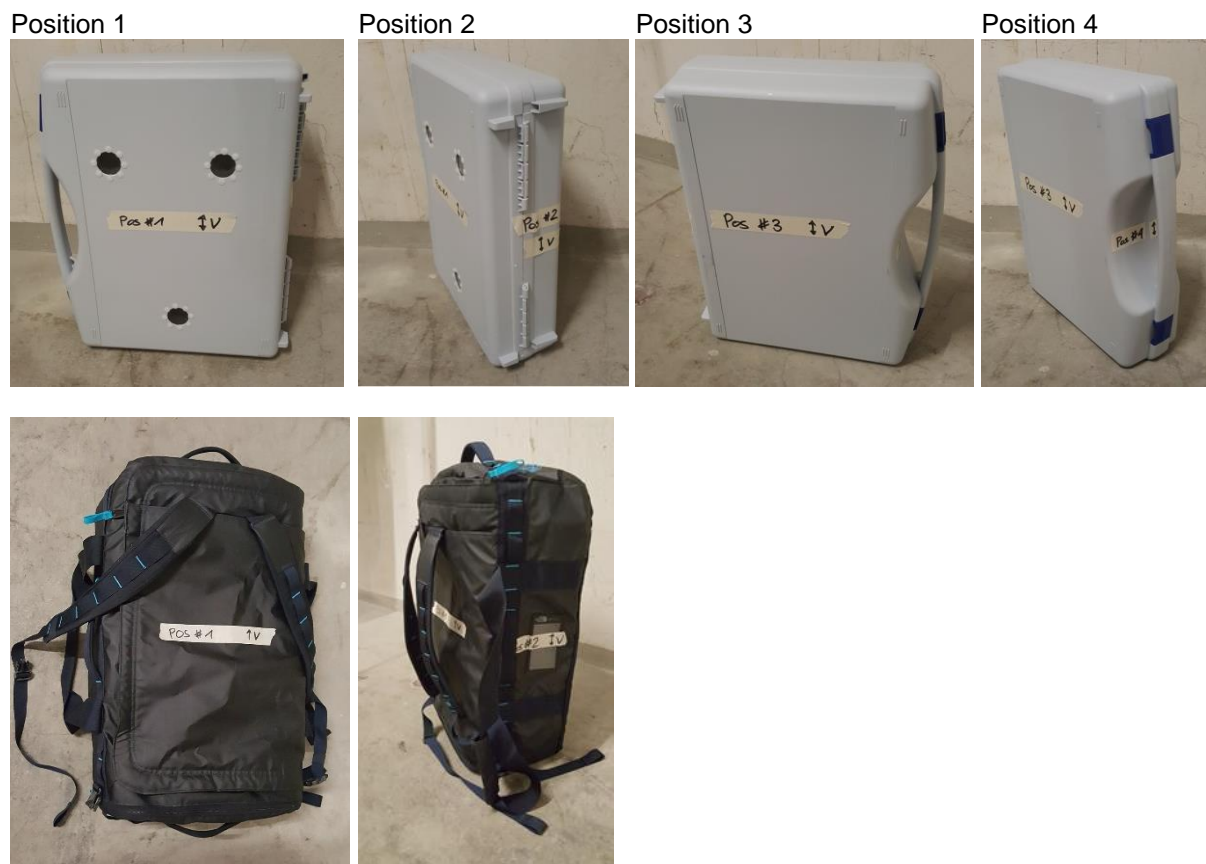
Abbildung 11: Bezeichnungen und Orientierung des Messkoffers und Rucksacks mit Definition der Polarisation des einfallenden Feldes
