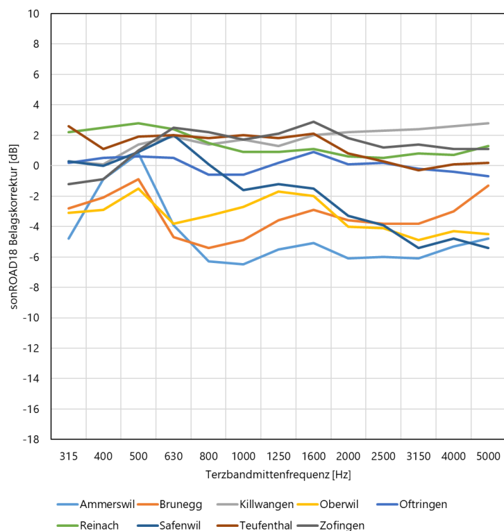
Abbildung 6.7: Aus den SPB-Daten der Datensammlung SPB G+P 3 abgeleitete sonROAD18-Belagskorrekturspektren.
