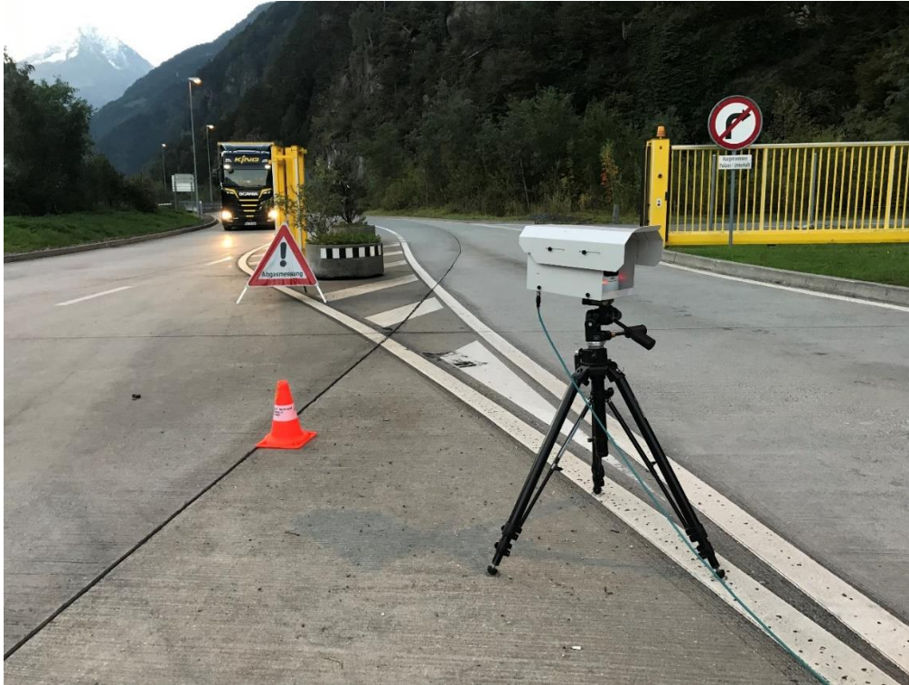
Abbildung 3: Messaufbau RSD-System: Kamera zur Erfassung von Fahrzeugfrontseite inkl. Nummernschild.
