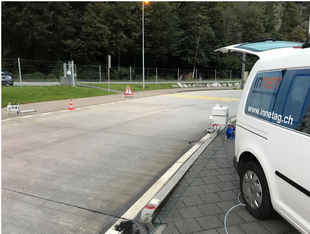
Abbildung 2: Messaufbau RSD-System: Datenverarbeitung im Messfahrzeug, Lichtquelle und Spektrometer sowie auf der gegenüberliegenden Seite Reflektor und Lateralversatz sowie Geschwindigkeits- und Beschleunigungsmessung.
