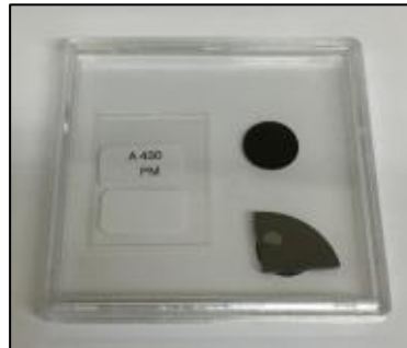
Abbildung 6: links: Sigma-2 Passivsammler; rechts: Haftoberfläche mit verschiedenen Substraten (Bor: unten rechts, C-Pad: oben rechts und Glasoberfläche: links)
