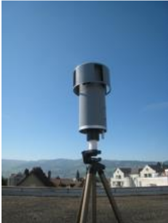
Abbildung 6: links: Sigma-2 Passivsammler; rechts: Haftoberfläche mit verschiedenen Substraten (Bor: unten rechts, C-Pad: oben rechts und Glasoberfläche: links)
