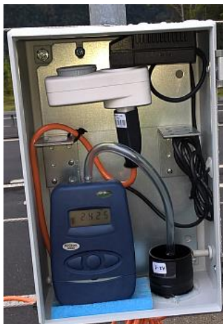
Abbildung 7: SKC Airchek3000 (links) und Probenahmegehäuse mit Polycarbonatfilter (rechts).
