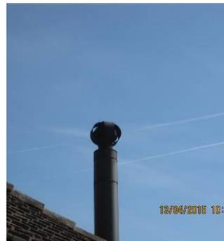
Abbildung 6.4: Minute 26, kein Rauch sichtbar, CO 470 mg/m<sup>3</sup>
