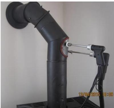
Abbildung 9.10: Relativ einfacher Messaufbau im Verbindungsrohr
