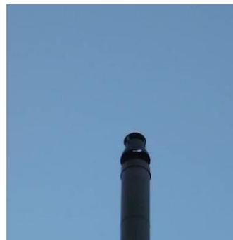
Abbildung 6.2: Minute 25, kein Rauch sichtbar, CO 1150 mg/m<sup>3</sup>
