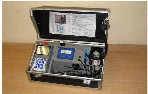
Abbildung 2.1: CO-Messgerät Typ ecom-J2KN
