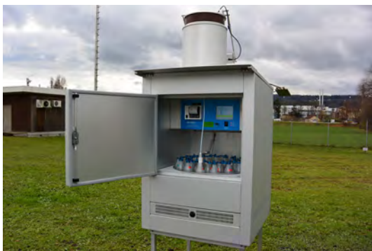
Abb. 3-24: Probenahme mit Regensammler
