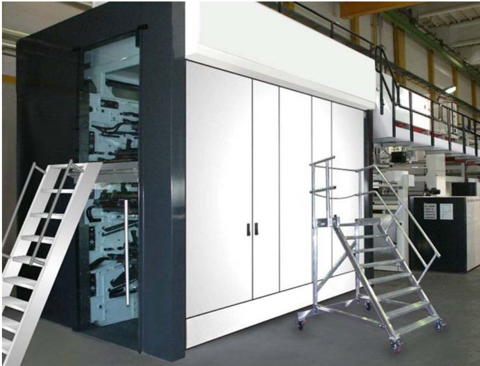
Abb. 3 > Vollständig gekapseltes Flexodruckwerk (Sicherheitsglas zur Sichtkontrolle)
