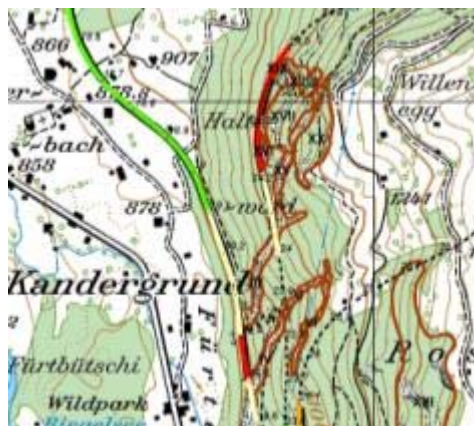
Abbildung 13: Das Kollektivrisiko auf der Strecke ist in einer quantitativen Abstufung von klein (hellgrüne Linie) bis sehr gross (rote Linie) dargestellt, die Umhüllenden der massgebenden Liefergebiete sind braun dargestellt.
