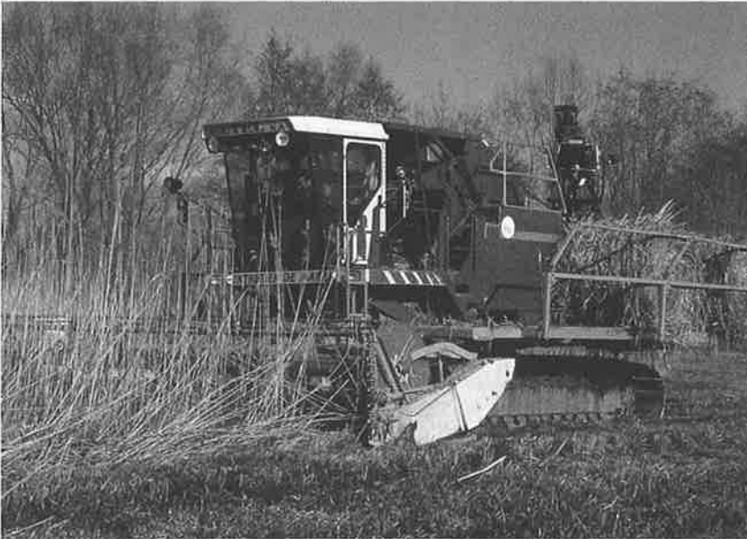
Abb. 1: Die Mähmaschine Elbotel wurde zum Mähen grosser Riedflächen entwickelt. Sie hat folgende Merkmale: Breite des Mähbalkens: 6,2 m, Ladekapazität: 6 t, Fahrgeschwindigkeit: 5 km/h. Die Maschine mäht, presst und führt das Schnittgut aus dem Ried hinaus, und das in einem Arbeitsrhythmus von durchschnittlich 1 ha pro Tag. Dank dieser grossen Kapazität können die Mäharbeiten jeweils bis spätestens anfangs Februar abgeschlossen werden, bevor die Wanderung der Amphibien beginnt. Allerdings wiegt die voll beladene Maschine 26 t. Da das Gewicht aber auf zwei Raupen von insgesamt 12 m 2 verteilt wird, entspricht der verursachte Bodendruck nur etwa dem eines Menschen.
