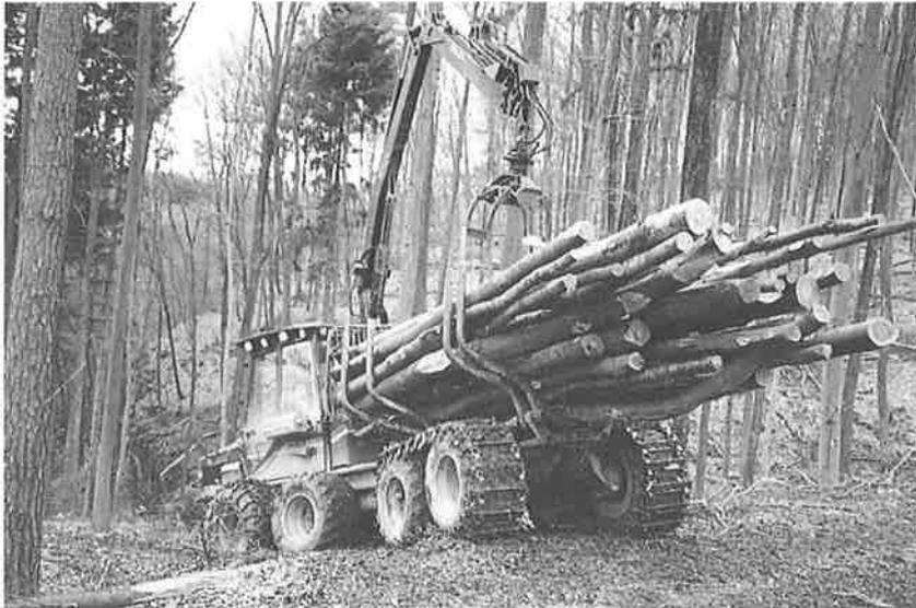
Abb. 3: Leistungsstarker Forwarder mit aufgezogenen Raupenbändern an den hinteren Radpaaren
