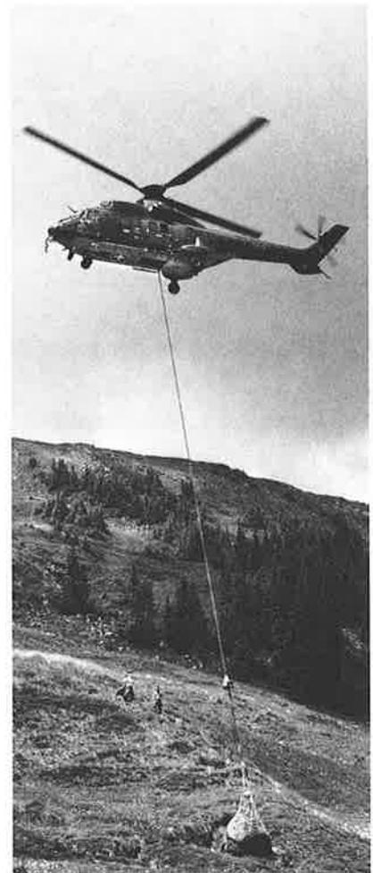
Abb. 1: Helikopter transportiert einen vorfabrizierten Trefferanzeiganlagen (TAA)-Kasten zur Baustelle.
