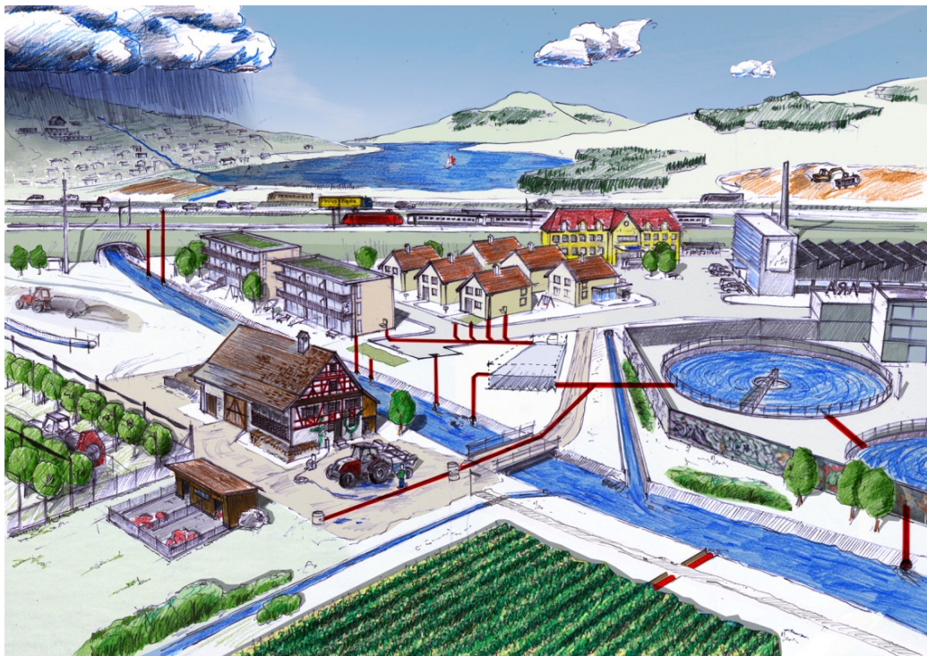
Abbildung 1 Übersicht einiger wichtiger Quellen und Eintragspfade (rot) von Mikroverunreinigungen. Als diffuse Einträge werden alle jene bezeichnet, die nicht über die Kläranlage in die Gewässer gelangen (© Bild: BAFU).
