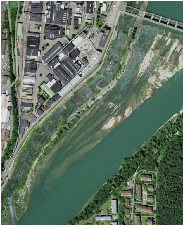
Umgehungsgerinne mit mittlerweile ausgebildetem Bewuchs und teilweise trockengefallene ehemalige Stromschnelle Gwild (Bild: Energiedienst)
