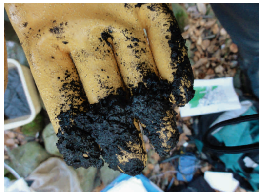
Abb. 4 Verschiedene Ablagerungen von Feinsedimenten aus der Strassentwässerung.
