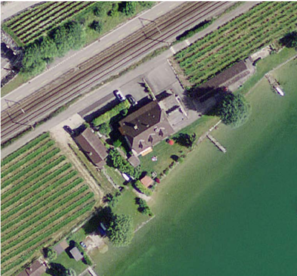
Abb. 4 > Vertikale Strukturen der Ufermauer sind – auch wenn nicht von Vegetation bedeckt – im Orthobild nicht erkennbar
