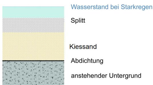
Abb. IV.6 Schematische Darstellung eines Splitt-Kiesfilters.
