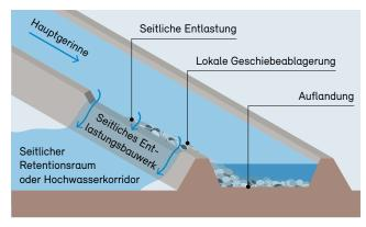
seitliche Entlastungsbauwerke, die keine Rücksicht auf die Auflandung nehmen, befinden sich in Bühlmann und Boes (2014), Giesecke *et al.* (2014) und Jäggi *et al.* (2015). Um die Auswirkung der Erhöhung der Sohlenlage auf die seitliche Entlastung zu berücksichtigen, führte Rosier (2007) im Labor des Forschungsinstituts PL-LCH der EPFL mehrere Rinnenexperimente durch.
