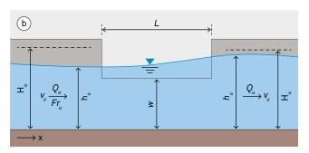
Abschätzung des seitlichen Entlastungsabflusses  $Q_{\scriptscriptstyle D}$ , die in der Regel auf der Annahme beruhen, dass am Streichwehr kein Energieverlust entsteht.
