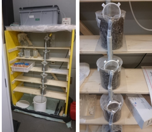
Abb. 4.13: Schema des Kaskadenversuches und Bild der Anlage. Chromatlösung wird in die Röhre in den Schlackenbechern aufgegeben und strömt nach oben durch die KVA-Schlacke. Im Überstand wurde der verfolgt, wann Chromat durchbricht
