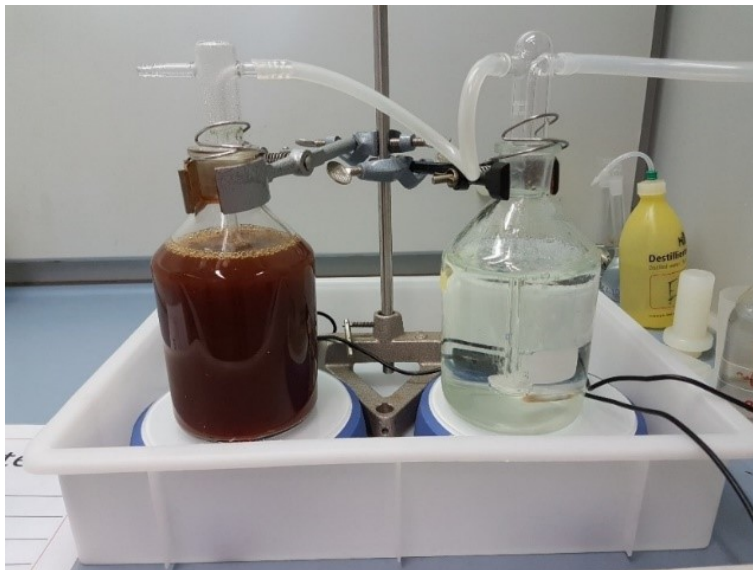
Abb. 4.3: Der Versuchsaufbau zur H_2 Begasung von Chromat- und Eisen(III)-Lösung. Weder Chromat noch Eisen(III) wurde durch atomaren Wasserstoff reduziert.
