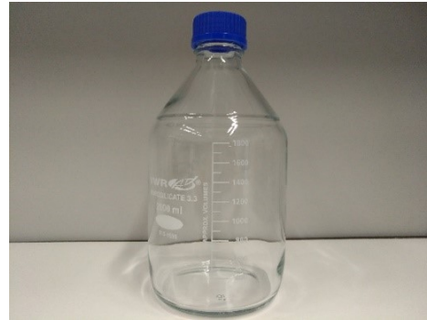
Probenbehälter für 24 h Fixierungs- und Auswaschversuche
