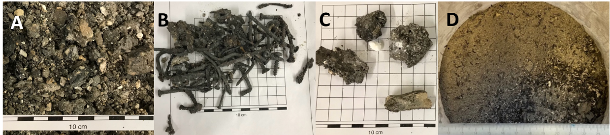
Abbildung 6: Rostaschen. A – verschlackte Rostasche; B – aus A aussortierte Fe-Metalle; C – aus A aussortierte Schlackeaggregate; D – lose Schlacke mit schwarzen Kohlepartikeln und hellen Gesteinskörnern.
