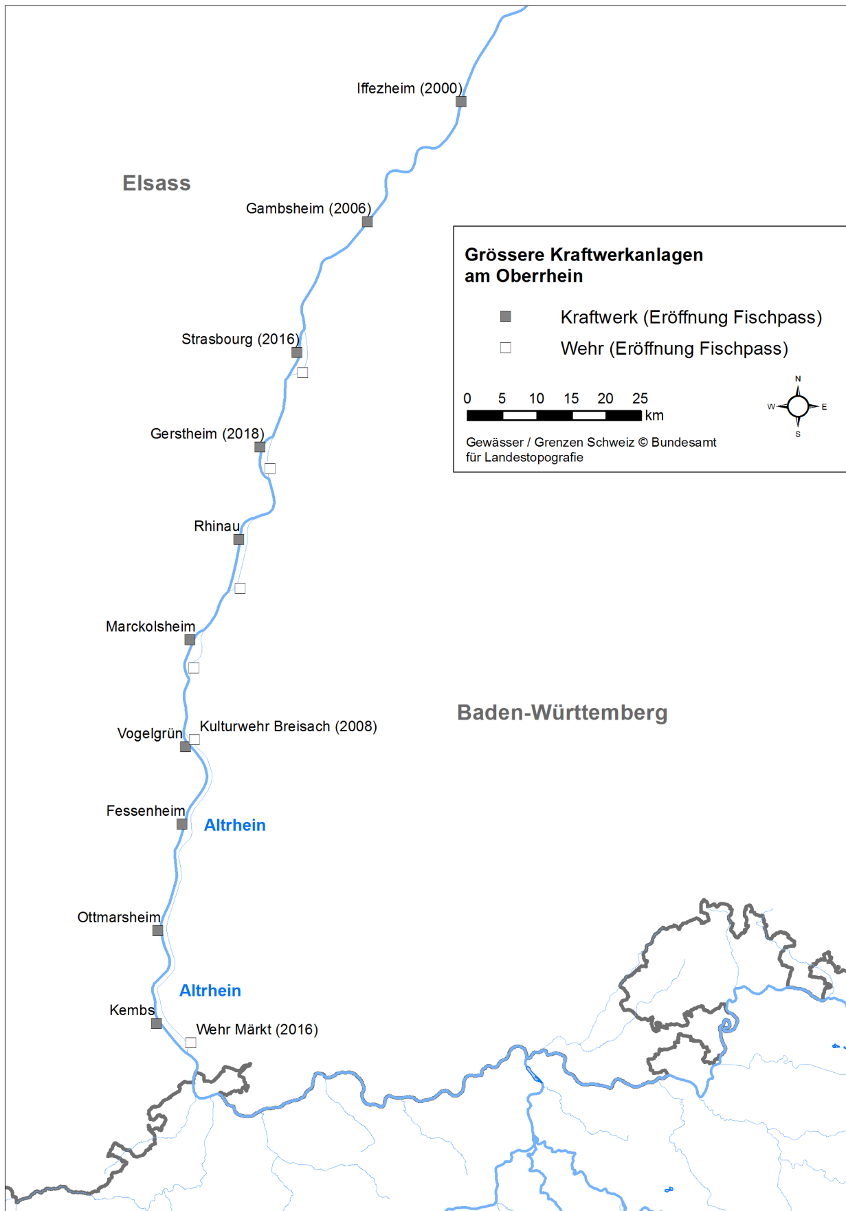
Abb. 4 Grössere Kraftwerksanlagen am Oberrhein inkl. Angabe des Eröffnungsjahrs der Fischaufstiegshilfe sofern vorhanden bzw. geplant.
