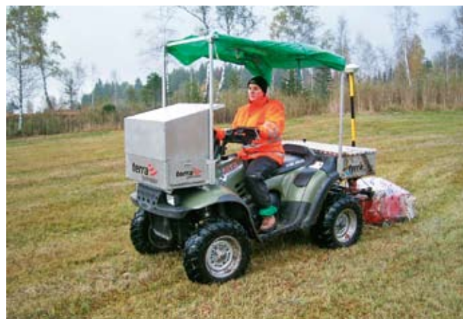
Abb. 4 Auf einem Quad montiertes Georadargerät
