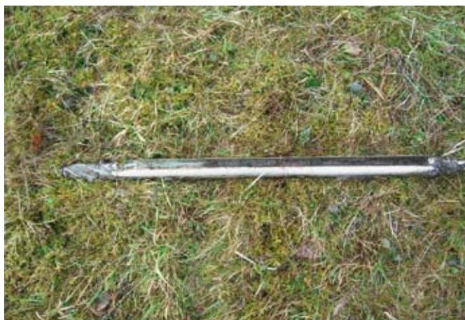
Abb. 3 Bohrer (Modell Hiller), mit Mergel und Torf gefüllte Probenkammer
