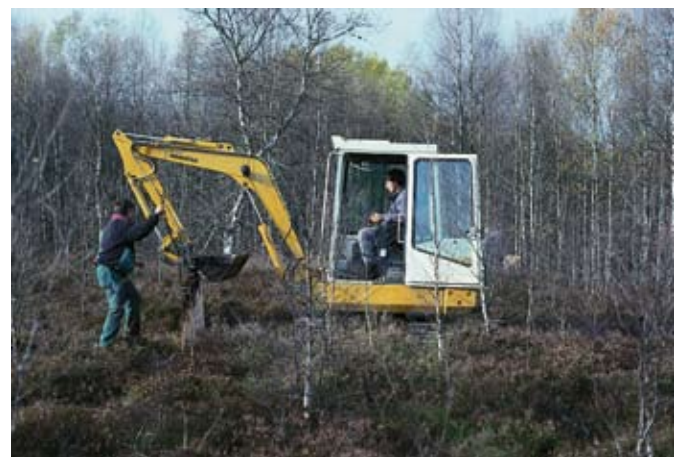
Abb. 67 10- bis 12-t-Kleinbagger mit Raupen
