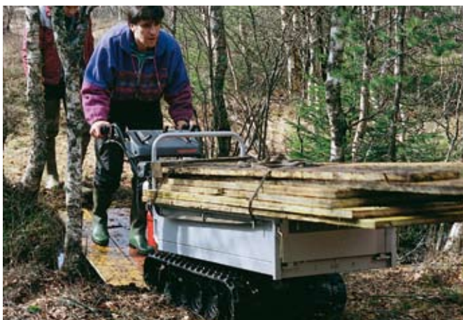
Abb. 66 Motorschubkarre auf Raupen für den Materialtransport
