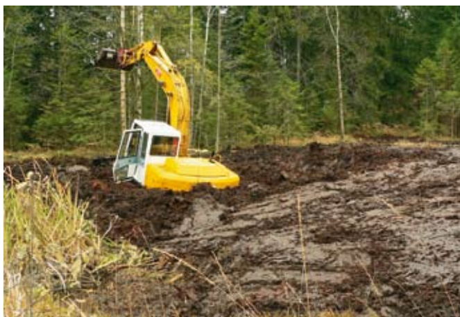
Abb. 31 Im Torf eingesunkener Kleinbagger
