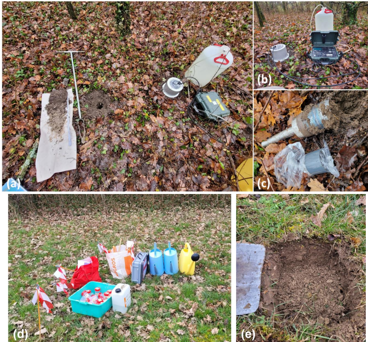
Figur 3. (a) Beispiel einer Handsondierung im Flaumeichenbereich von Hauterive-St-Blaise. (b) Saturo-Infiltrometer der Meter Group, der zur Bestimmung der gesättigten Wasserleitfähigkeit verwendet wurde. (c) Probenahme von Bodenzylindern zur Messung der Dichte und Porosität der Oberflächenhorizonte. (d) Material für die Regenwurmextraktion. (e) Erste Phase beim Ausgraben eines Bodenprofils. © Bildnachweis: Teo Zanini (a, b, c), Claire Le Bayon (d, e).
