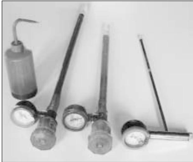
**Abb. 47: Manometer-Tensiometer verschiedener Baulängen/-arten und Zubehör.**
