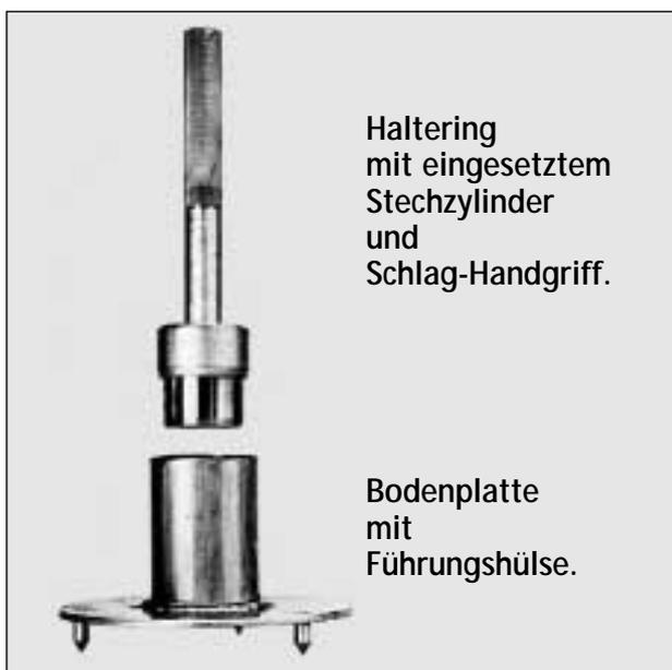
Abb. 48: Die Abbildung zeigt ein 100 ml Entnahmeset.
