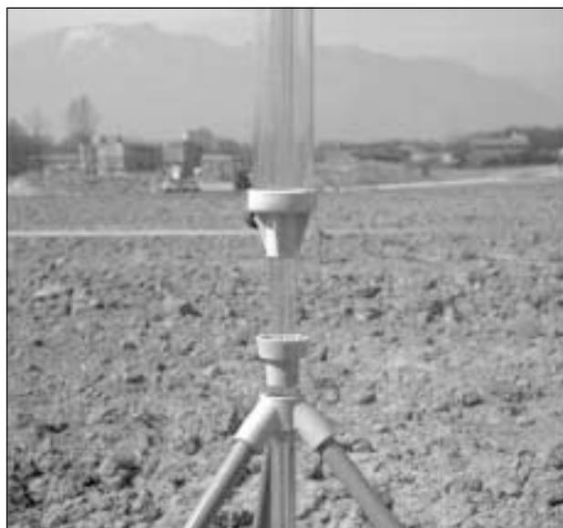
Abb. 45: Kontrolle der Wasserdurchlässigkeit einer grossen Geländeaufschüttung anlässlich einer Feldkampagne des IATE/EPFL (Al Carcale, 1994) bei Gordola (TI).
