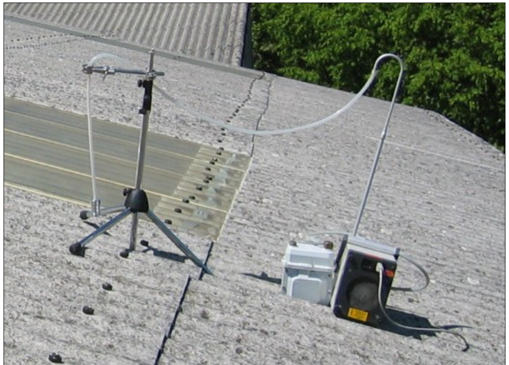
Abb. 1: Aufbau der Probenahmeeinrichtung. Links der Einlasskopf, in der Mitte die Filtereinheit und rechts die Pumpe.
