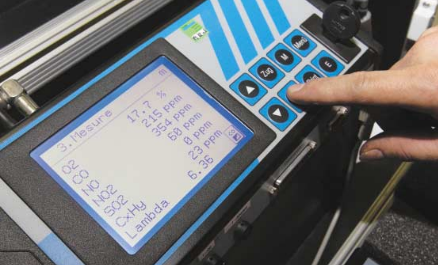
Der öffentliche Verkehr auf dem Prüfstand: Abgasmessung bei einem Dieselbus der Bieler Verkehrsbetriebe
