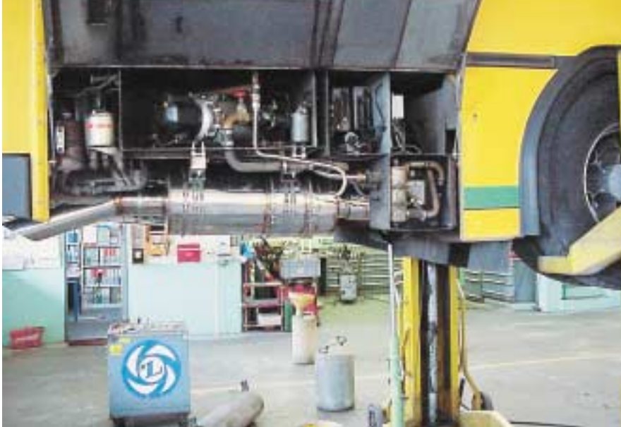
Porträt eines Umweltschützers: Der Partikelfilter in diesem Dieselbus ersetzt den Schalldämpfer und hält über 99 Prozent der gefährlichen Russpartikel zurück.
