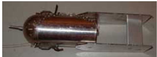
Figur 29: Entnahmegesetz an Leine, 1970, SGLN für Schwebstoffe.
