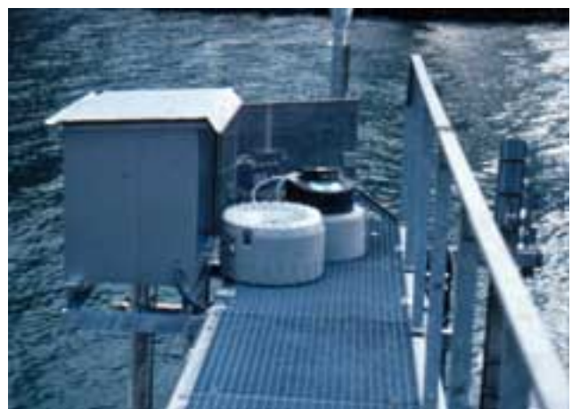
Figur 32: Entnahmegesetz ISCO 6700 für Schwebstoffe.
