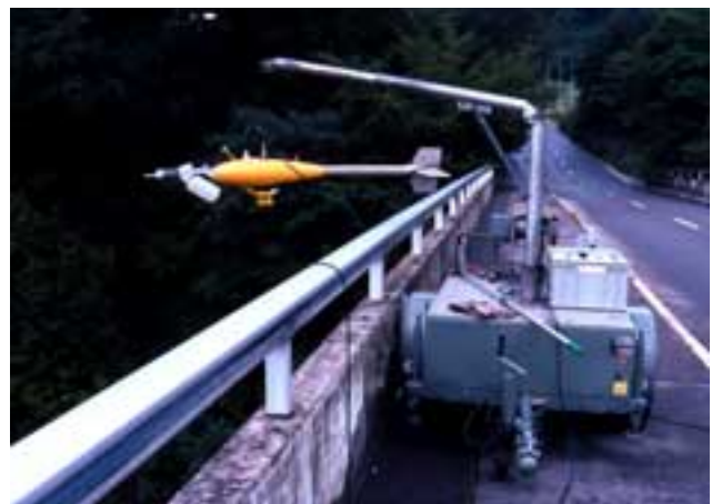
Figur 30: Messwagen der Landeshydrologie für Schwebstoffprobenentnahmen, im Einsatz bis 1999.
