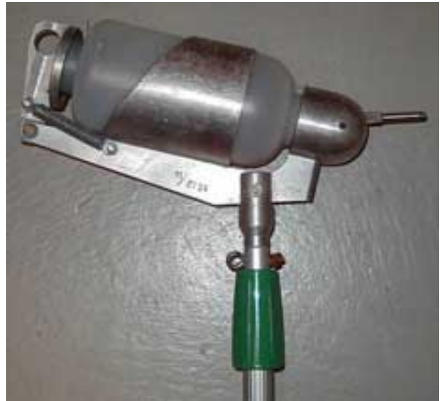
Figur 28: Entnahmegesetz an Stange, SGS für Schwebstoffe.
