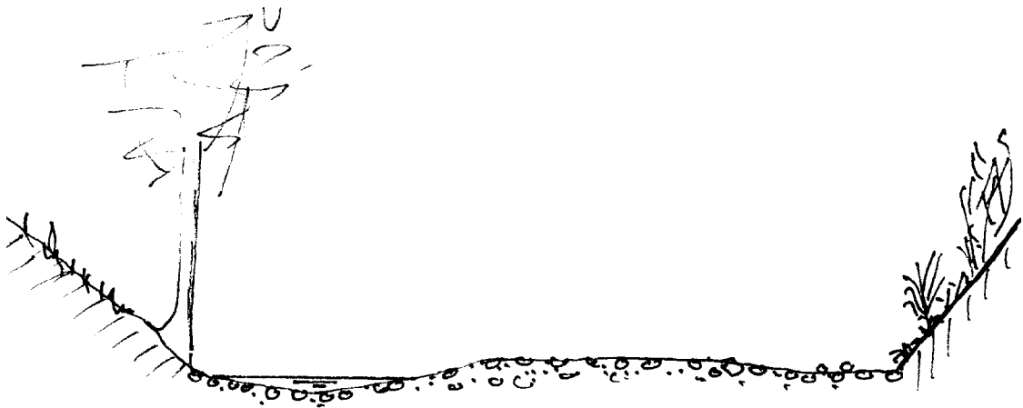
Typisches Querprofil der Versuchsstrecke Brüttenbach (Umlagerungsstrecke) – Brüttental
