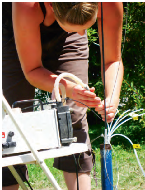
Grundwassersanierung bei Lyss (BE): Statt den verseuchten Boden auszuheben, wird Natrium-Permanganat in den Schadenherd gepumpt. Das Oxidationsmittel wandelt das giftige Perchlorethylen (Per) in harmlose Endprodukte um. Die Probeentnahme (Bild links und Mitte: Installation und Vorbereitung) bringt das violette Oxidationsmittel wieder zum Vorschein (Bild rechts).
